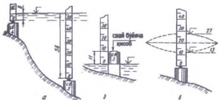
11.1 – rasm. Suv o'lchash postlarida suv sathini o'lchash variantlari: a – ikki svay bo'yicha; b – kuzatish nulidan pastda joylashgan suv sathi bo'lganda; v – erkin sathda to'liqinlanish bo'lgan sharoitda. O'lchamlari sm. da.
