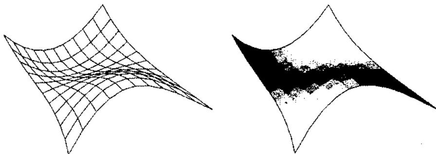
Рис. 5.53. Аппроксимация гладкой поверхности сплайна
