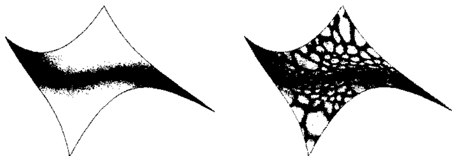
Рис. 5.54. Закраска Гуро и наложение текстуры
