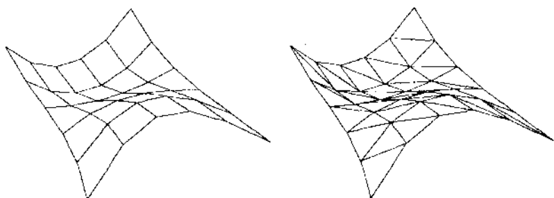
Рис. 5.55. "Квадратирование" и триангуляция
