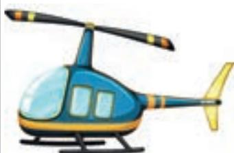
**4 слайд. Вертолет** – винтокрылый летательный аппарат вертикального взлета и посадки, подъемная сила которого зависит от одного или нескольких (обычно двух) пропеллеров. Вертолет может взлетать, садиться вертикально, зависать в небе, поворачиваться в любом направлении вокруг вертикальной оси и лететь в любом направлении.
