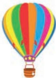
**3 слайд. Воздушный шар** – летательный аппарат (аэростат), в котором для полета используют газ легче воздуха. Аэростаты назвали «воздушным шаром», потому что они имеют сферическую форму. Воздушный шар бывает двух видов: управляемый аэронавтом и неуправляемый аэронавтом. Воздушный шар, наполненный горячим воздухом, поднимается вверх. Он опускается вниз, когда температура воздуха в нем понижается.
