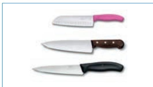
**Нож** – это инструмент с длинным острым лезвием, заточенным с одной стороны. Нож состоит из лезвия и рукояти. **Лезвие** – это режущая кромка клинка. Рукоять изготавливается из дерева, кости, пластика и, иногда, железа.
